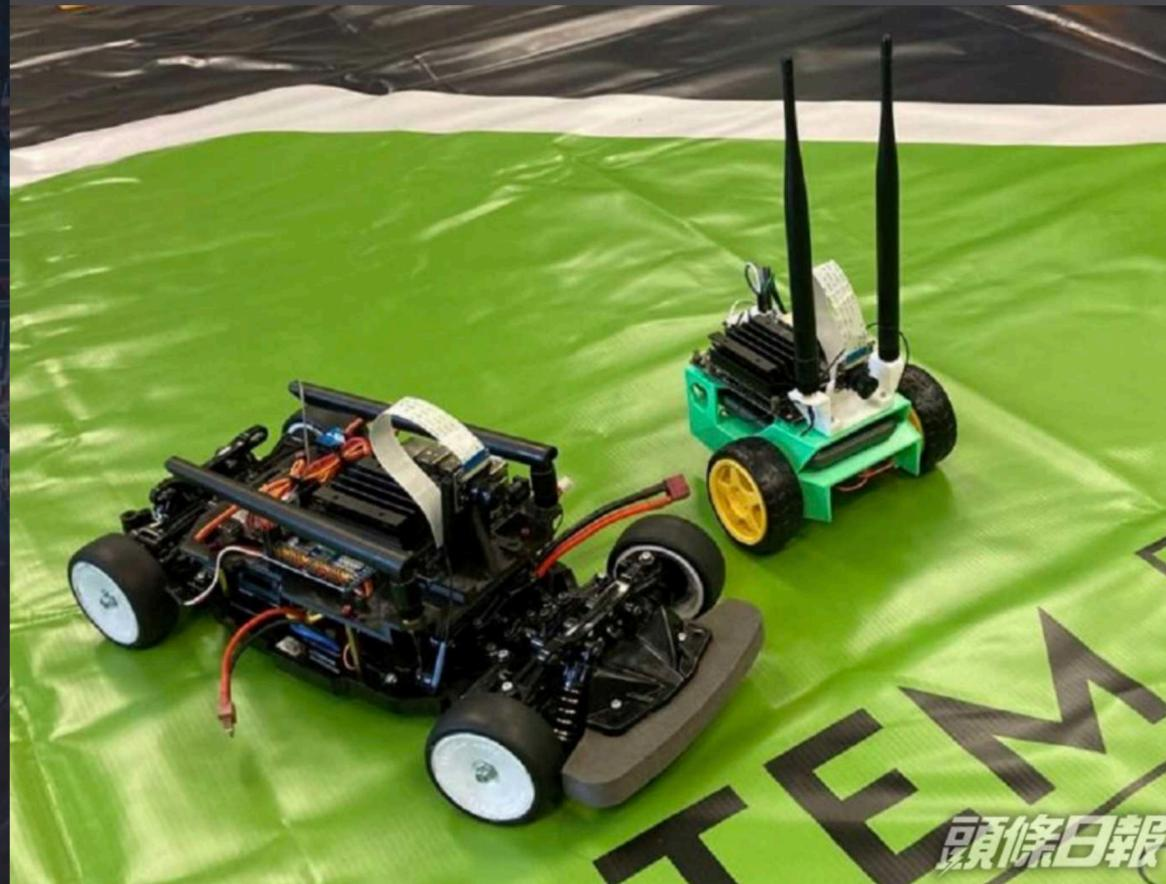
賽事的初級及高級組，分別以「JetBot」（右）及「JetRacer」的自動人工智能賽車，透過編程「學習」跟隨道路高速移動。網上圖片
